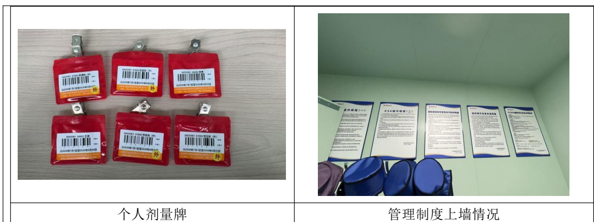
图3-3 本项目DSA手术室辐射安全与防护设施
