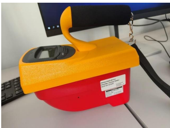
便携式X- \gamma 剂量率仪
