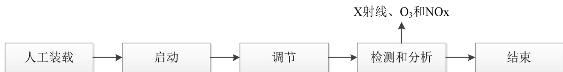
图 2-3 本项目工业 X 射线 CT 机工艺流程及产污环节示意图
