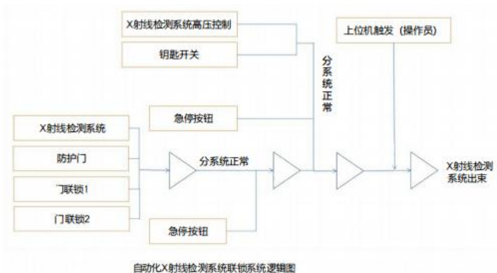
图 10-2 自动化 X 射线检测系统联锁装置逻辑关系图
