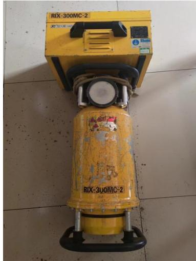
图 2-1 本项目 X 射线探伤机图片
