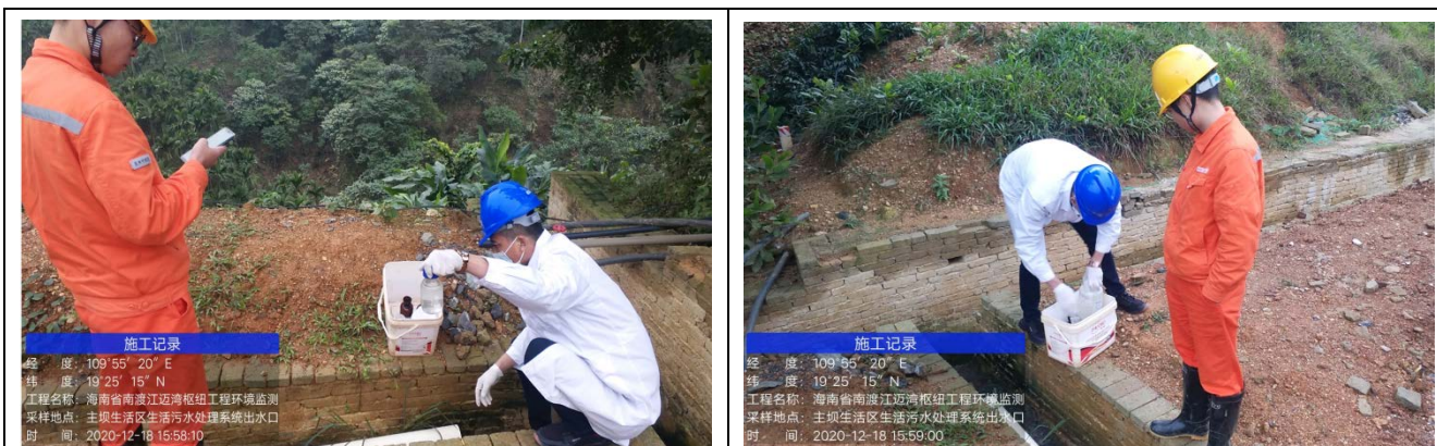
主坝生活区生活污水处理系统出水口水质采样
