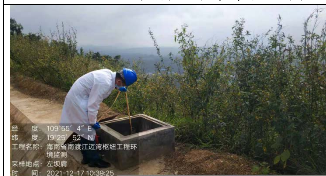
2021.12.17左坝肩地下水水位监测
