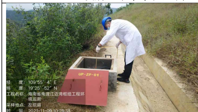
2021.11.09左坝肩地下水水位监测
