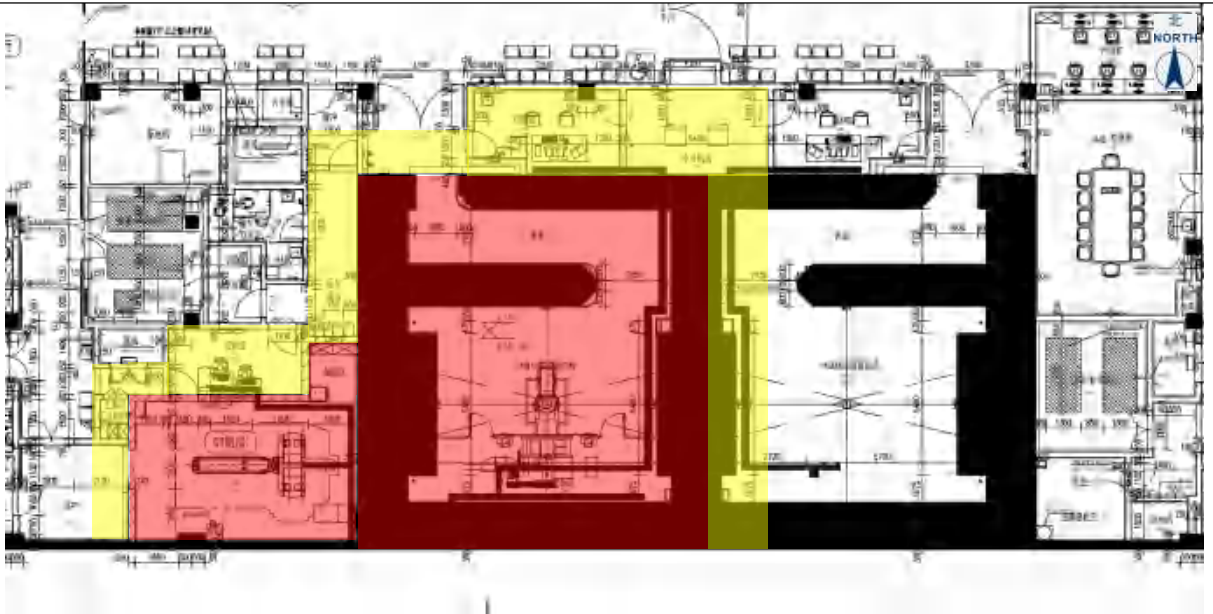
图 3-4 验收辐射工作场所控制区（红色）、监督区（黄色）示意图
