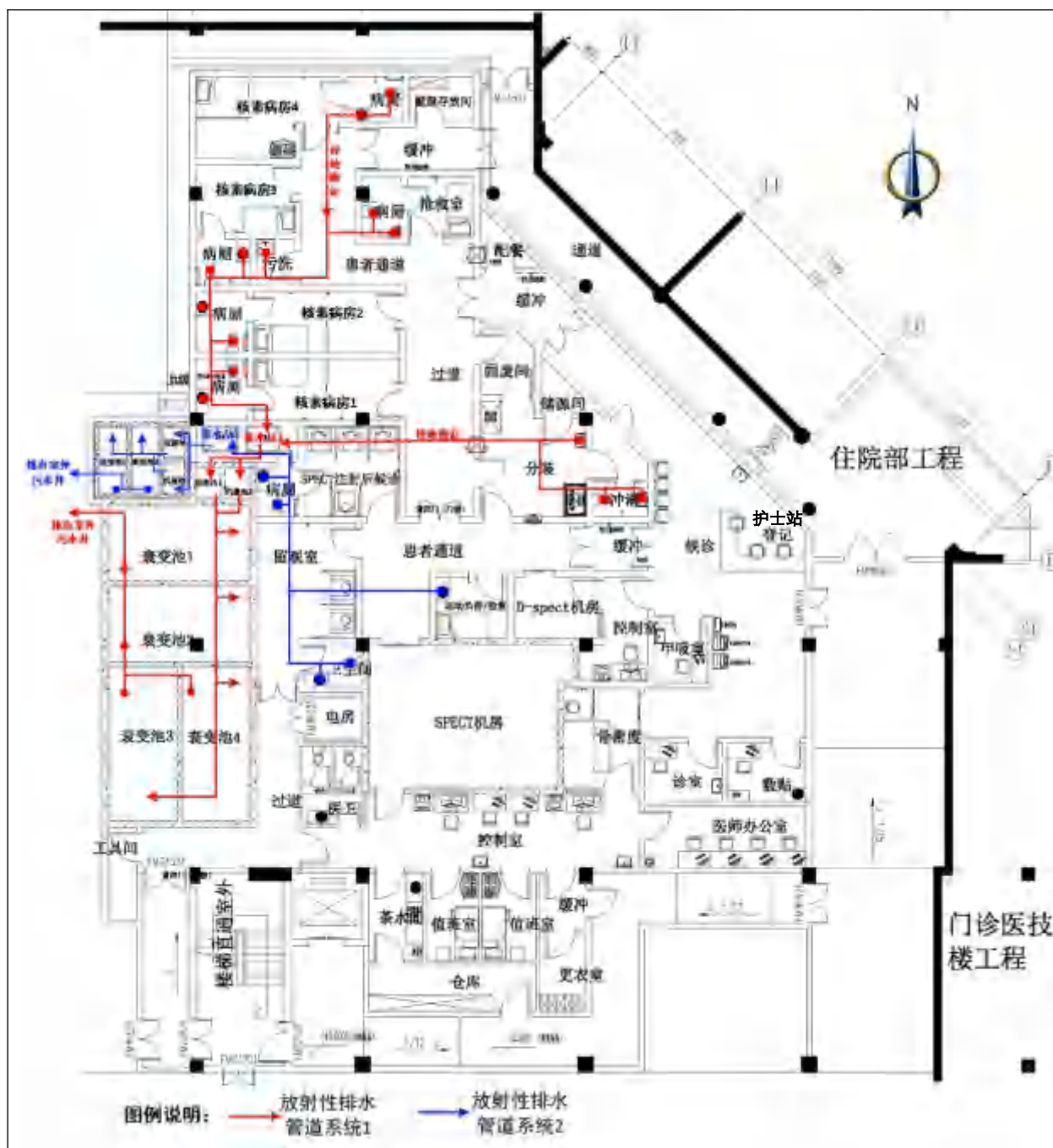
图3-23 南院区核医学科放射性废水管道布置示意图
