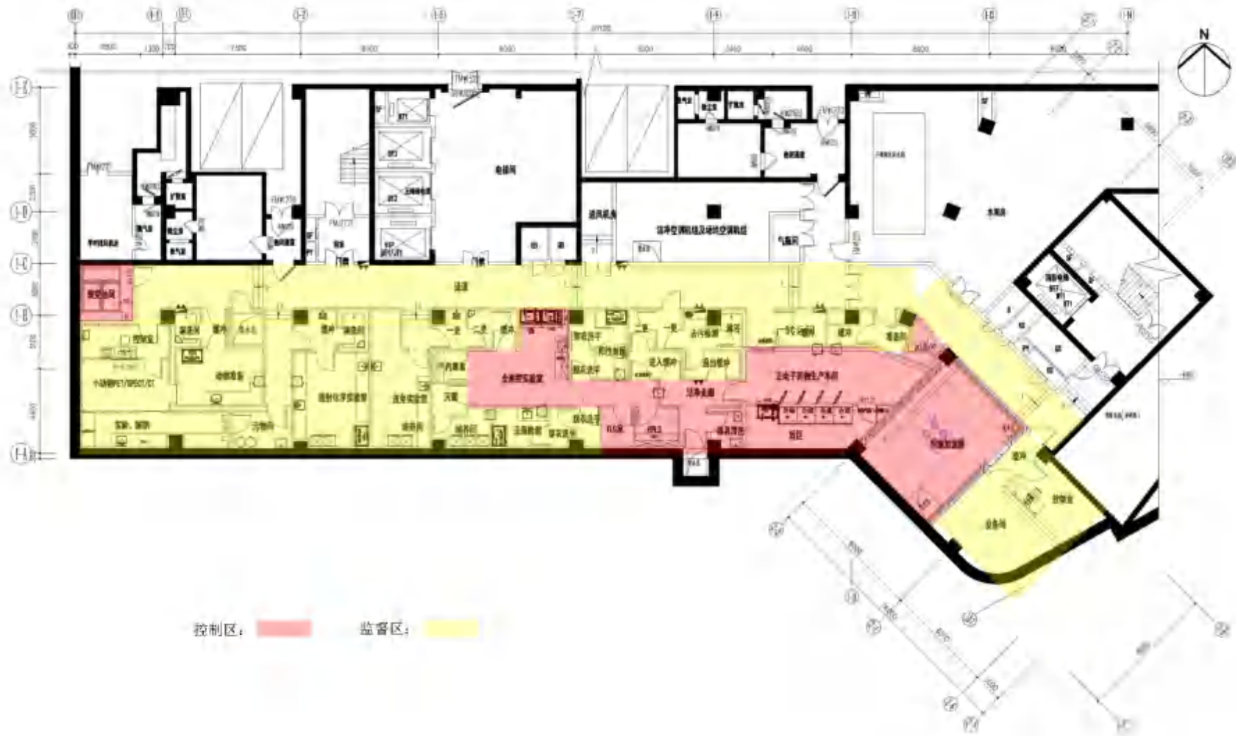
北院区放射性药物制备场所验收控制区（图中红色区域）、监督区（图中黄色区域）划分图 图 3-8 北院区放射性药物制备场所环评与验收控制区、监督区对比图
