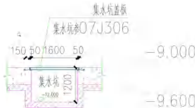
图 3-25 回旋加速器机房集水坑剖面图
