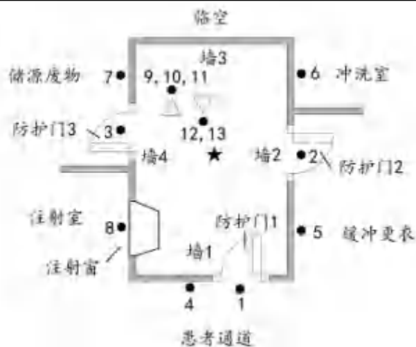
注射分装室工作场所检测布点示意图
