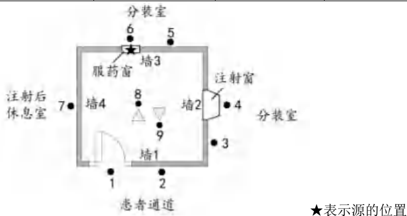
注射室工作场所检测布点示意图
