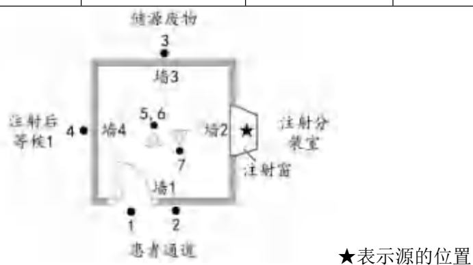
注射室工作场所检测布点示意图
