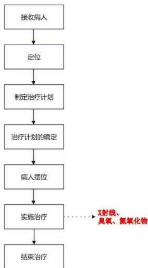
图 9-6 浅层 X 射线放射治疗系统操作流程及产污环节图
