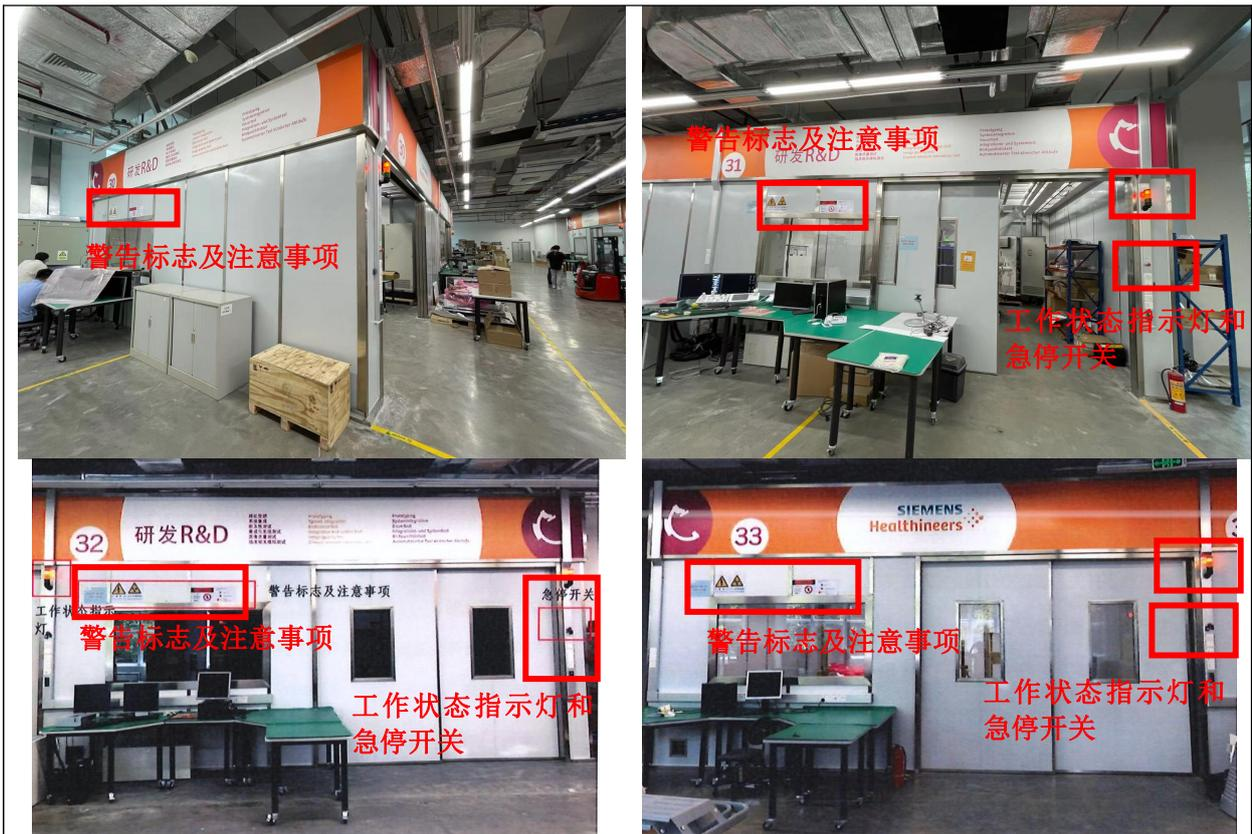
图 3-1 调试机房警示标识和安全装置现场图
