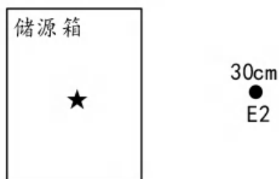
图 7-5 储源箱工作用品检测布点示意图
