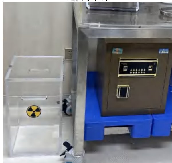
分装制作室有机玻璃废物桶、储源保险箱
