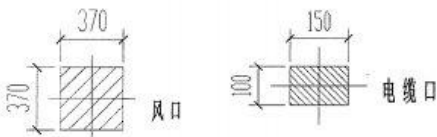
图 23, Bay 房房顶空调及线槽开孔图:
