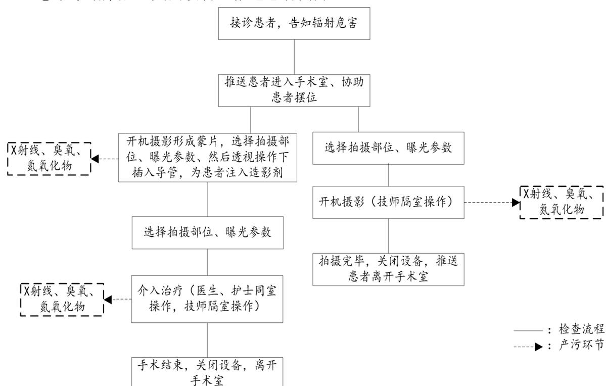
图 2-7 工艺流程及产污环节图
