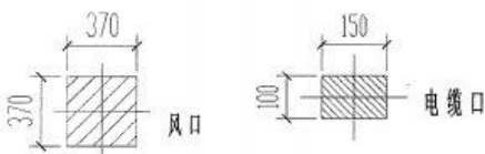
图 23, Bay 房房顶空调及线槽开孔图:
