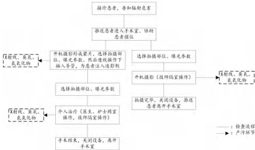
图9-5 介入手术工作流程及产污环节图
