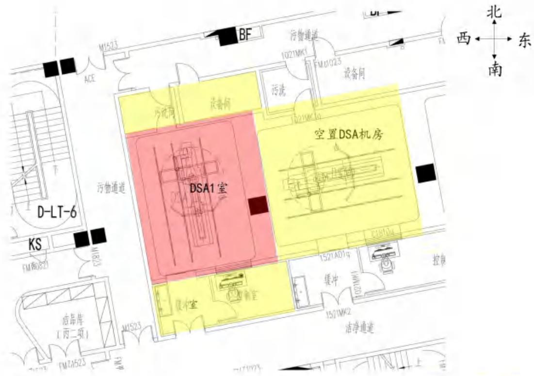
图 3-4 L2 层 DSA1 室验收辐射工作场所控制区、监督区示意图
