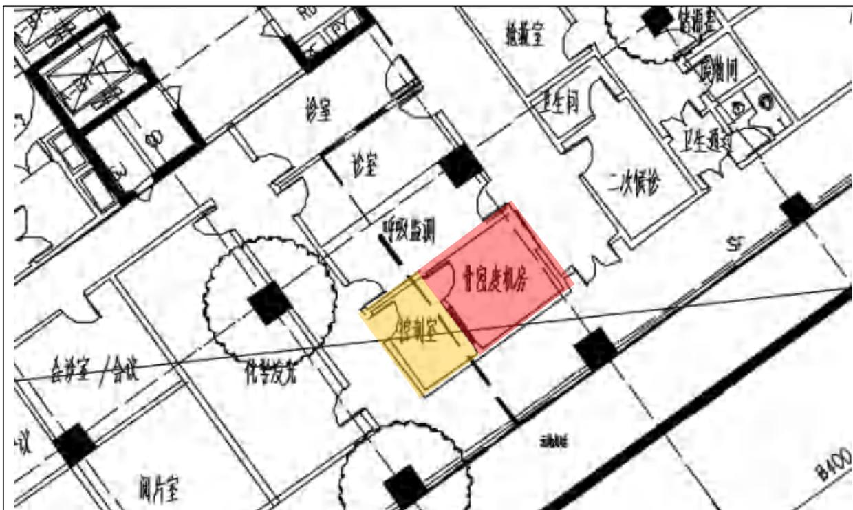
图 3-5 B1 层骨密度机房环评辐射工作场所控制区、监督区示意图
