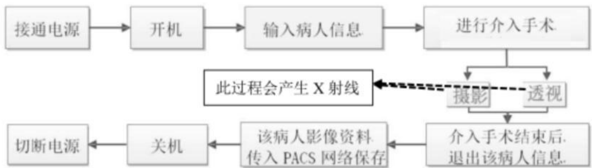
图 2-8 介入手术作流程及产污环节示意图
