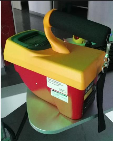
X- $\gamma$  辐射剂量率仪
