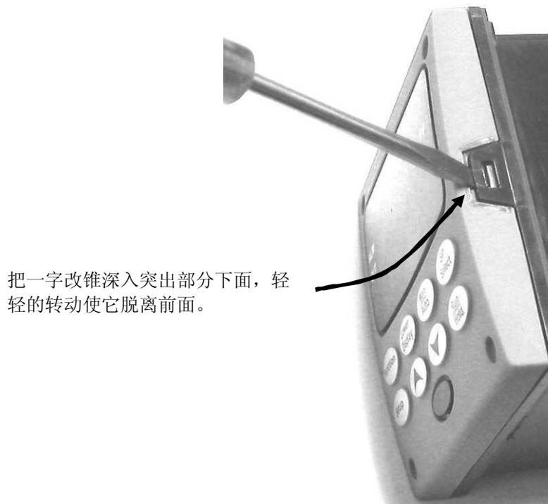
使用一把一字改锥，轻轻地转动从面板撬开薄片。撬得正好可以使其脱离，否则，会弄弯或弄坏薄片。如果弄弯或弄坏薄片而不能重新紧紧地贴回面板，您需要使用提供的 4 NEMA4 螺旋来重新拧紧薄片。参见29页 图表 2-3 安装方法
