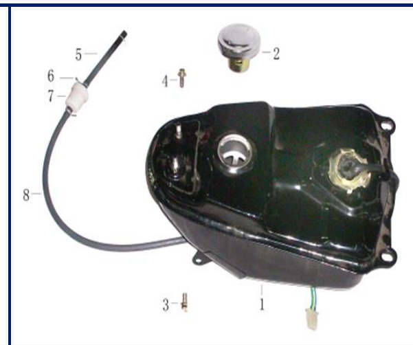
Figura N° 33: Tanque de combustible
