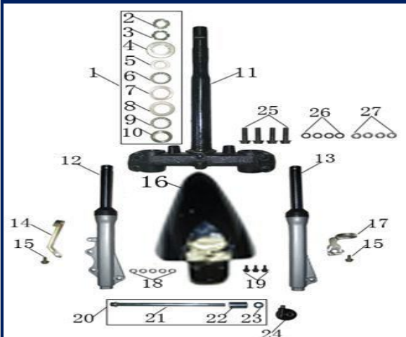
FIGURA N°10: T DE BARRAS Y AMORTIGUADORES
