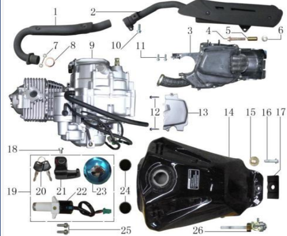
FIGURA N°11: ESCAPE Y TANQUE DE GASOLINA
