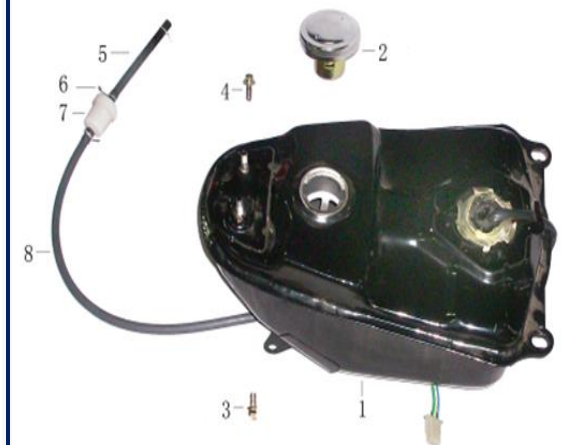
Figura N° 33: Tanque de combustible
