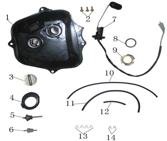
FIGURA N°27: TANQUE DE GASOLINA
