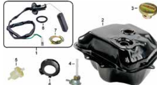
TANQUE DE COMBUSTIBLE F-17
