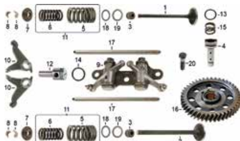
TREN DE VÁLVULAS E-4
