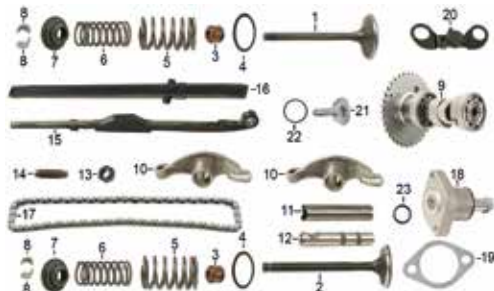
TREN DE VÁLVULAS E-4
