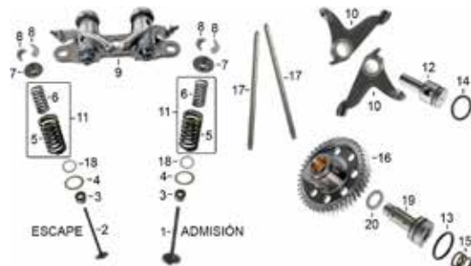
TREN DE VÁLVULAS E-4
