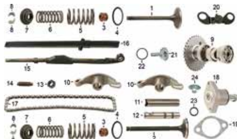
TREN DE VÁLVULAS E-4
