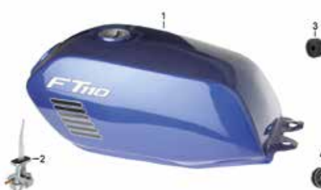
TANQUE DE COMBUSTIBLE F-17
