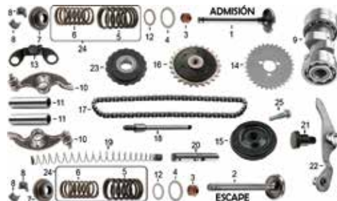
TREN DE VÁLVULAS E-4
