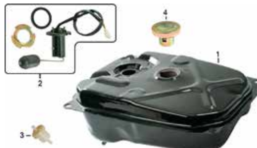
TANQUE DE COMBUSTIBLE F-17
