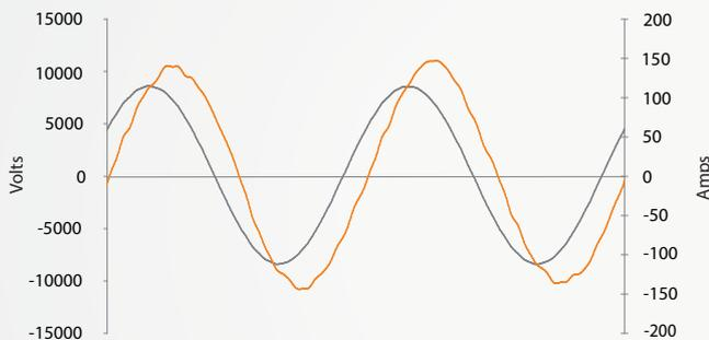
网侧电流 网侧电压
