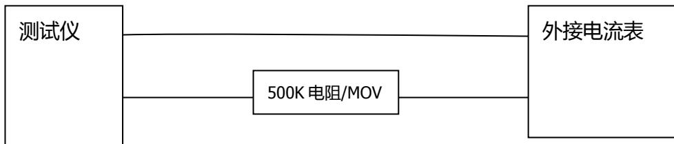
2. 电压验证：在负载电阻上并联电压表，电阻取值分别为和 100K 200K 300K……到 800K, 电阻阻值以 100K 递进。开机按**高压起停**按钮，仪器将开始缓启动输出电流，直到仪器显示达到 1000 uA 为止，稳定后观察外接电压表的读数，记录下外接电压表的电压值，以及仪器显示的电压值。每次更换负载电阻前，务必先按**高压起停**按钮，关闭输出后再更换负载电阻。
