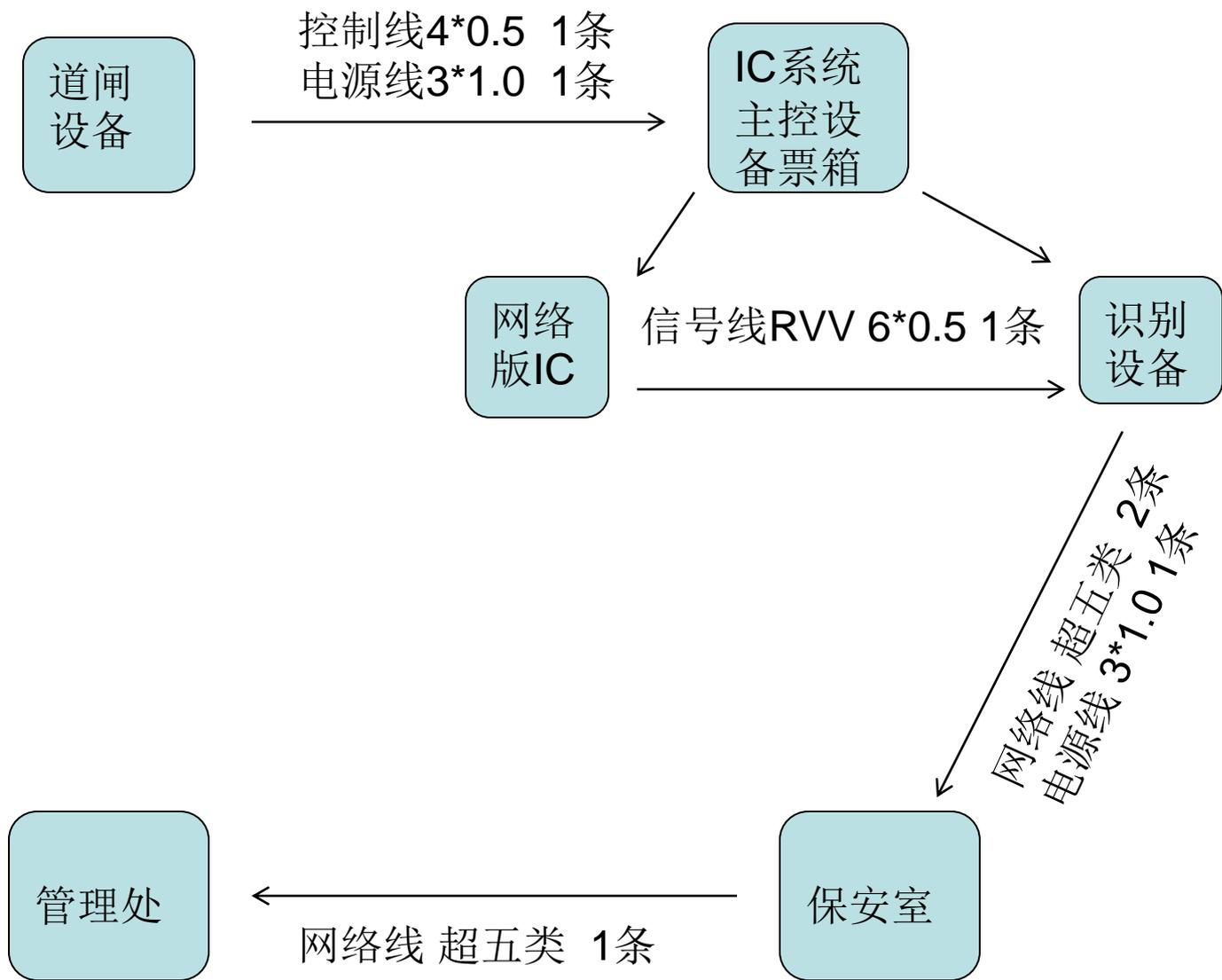
备注：三联开关需增加一条信号线：RVV $4 \times 0.5$
