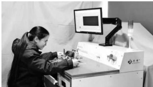
• 2023 年,应行业需要,思博公司成功研发了“角位移电位器综合测试台”,并作为专用非标设备推向市场,满足行业需求。该测试台可满足精密电位器、光电编码器等角度位移传感器的性能测试,表明思博公司拥有深厚的技术储备和强大的研发能力。
