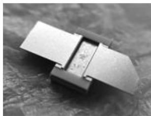
图 1 微波固态功率器件外壳
