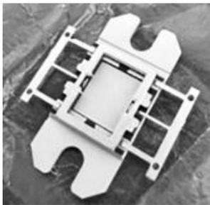
图 2 微波单片电路金属陶瓷外壳
