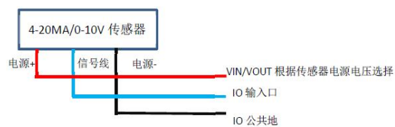
模拟量传感器接线（设备取电）
