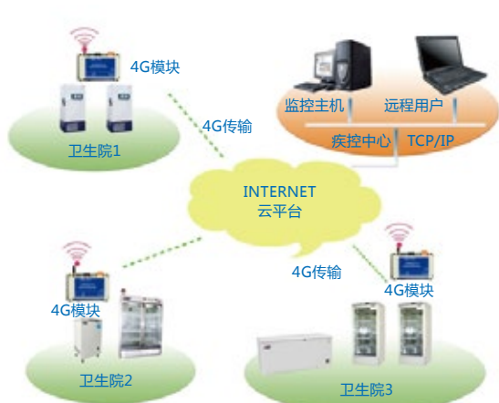
分布式冰箱温度集中管理系统（4G/CDMA方案）
