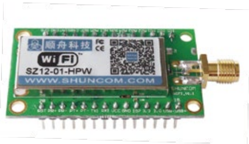
设备尺寸 48mmX27.6mmX13.2mm（长X宽X高）
