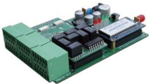
设备尺寸 133mmX84mmX24mm (长X宽X高)
