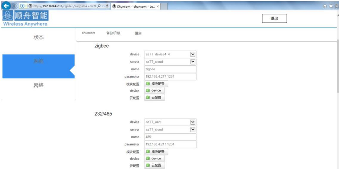
**device:** szTT\_device4\_4 （Zigbee 下行透明传输，配合顺舟 4.4 版本透传程序使用）
