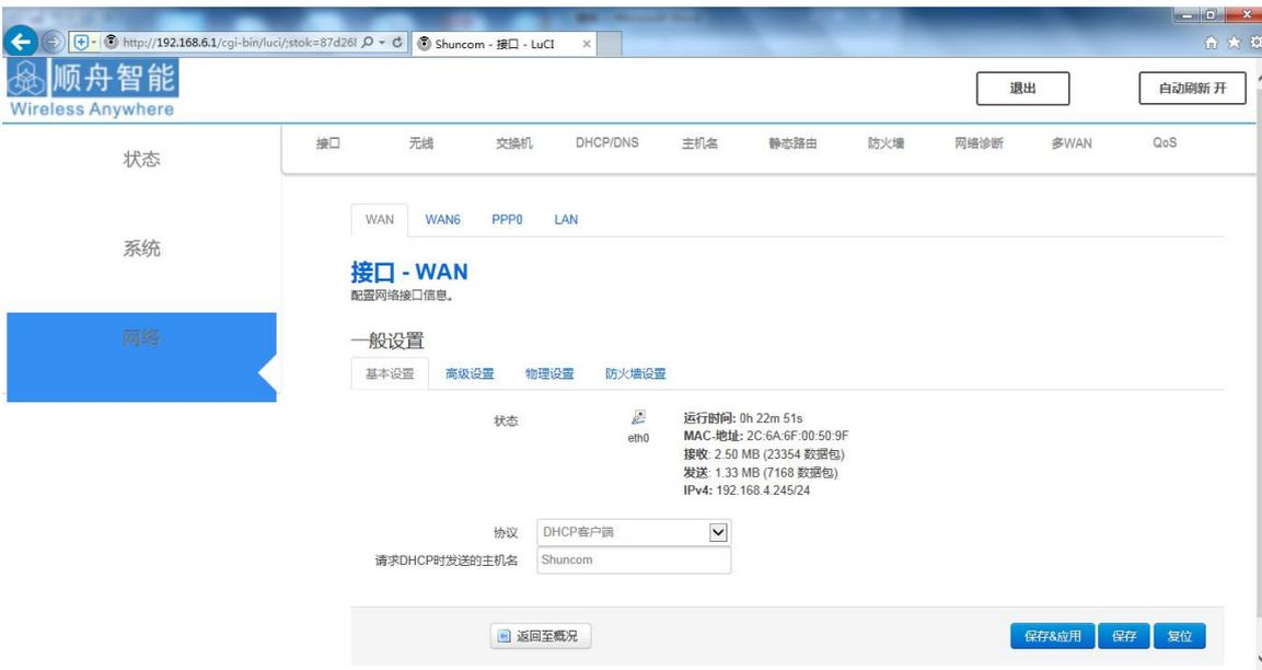
如使用 **4G** 上网，则将 **SIM** 卡正确插入网关后即可实现网络连接。如无法上网则查看“网络-接口-PPPO”里的参数，将调制解调器节点设为“/dev/ttyUSB5”。
