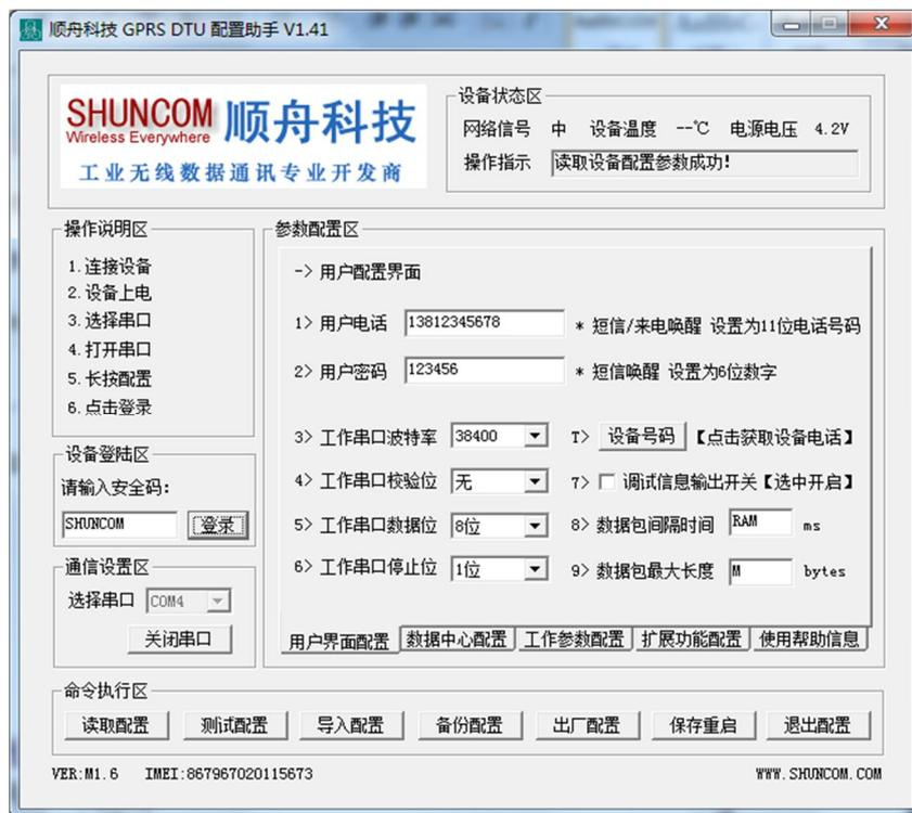
如模块已自动退出配置进入联网状态，可通拉低模块上的 CFG 脚 3S 后，模块进入配置状态，使用调试底板的话可直接长按配置按键 3S 进入配置。
