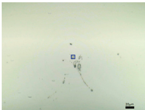
图 1 微小异物的显微镜图像（蓝框为 10 \mu\text{m} ） Microscope Image of Micro-Contaminants (shown with a 10 \mu\text{m} blue box)
