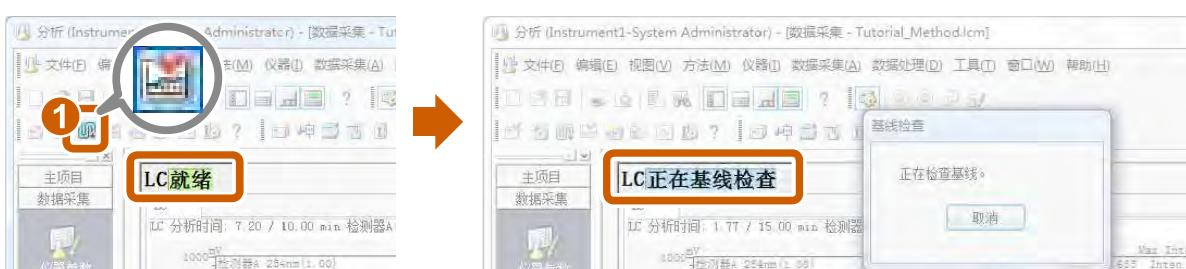
测定结束后，检查结果会在 [基线检查结果] 子窗口和 [输出窗口] 中显示。
