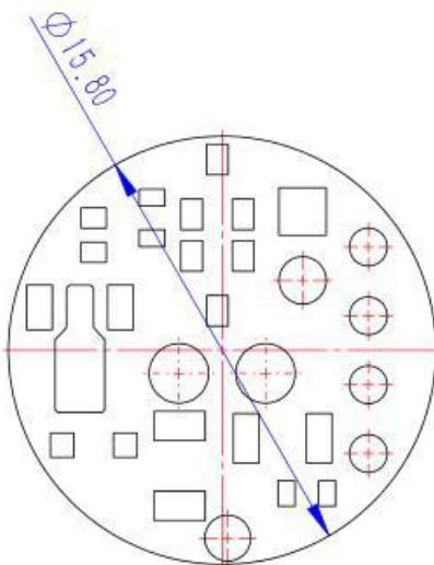
备注: 此变送板适合配陶瓷压阻芯体 (恒压供电)。
