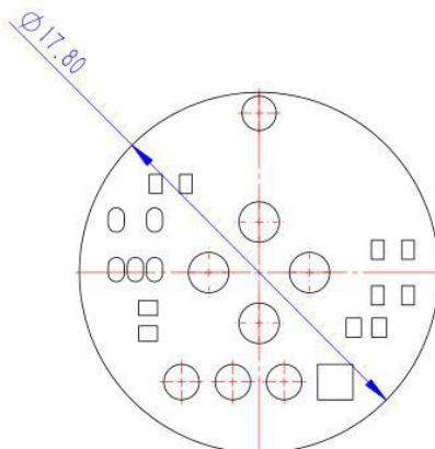
备注: 此变送板适合配应变计和陶瓷压阻芯体 (恒压供电)。
