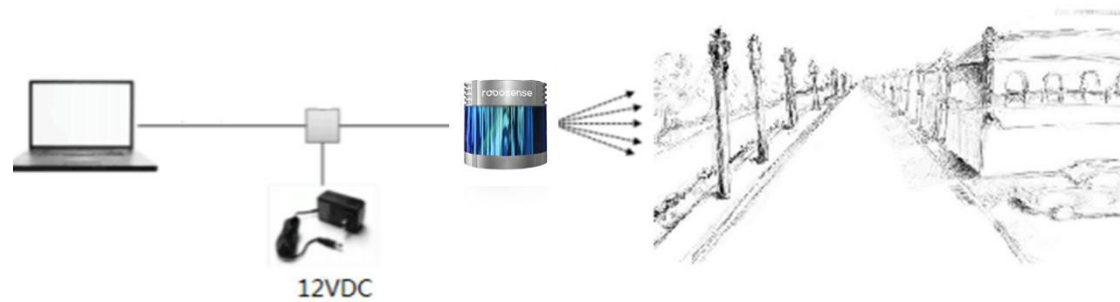
图 1 RS-LiDAR-32 激光雷达成像系统
