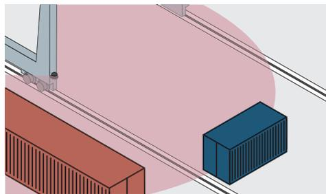
插图 18: 有烟雾过滤器: 通过消隐不必要的回波来可靠地检测物体。
