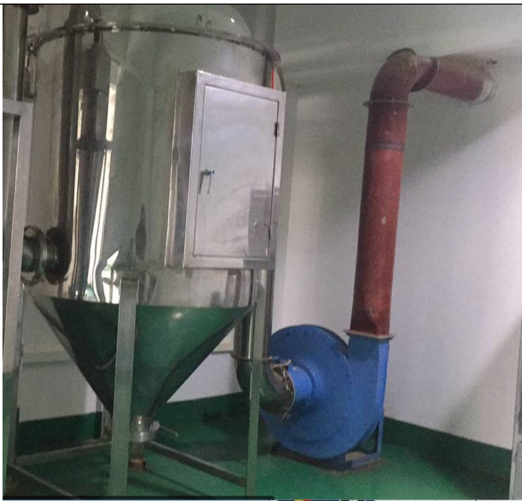
图 3-3 粉碎机负压抽风除尘设备
